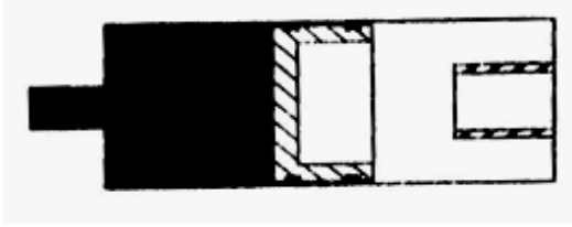
Şəkil 8.18. Hidravlik akkumlyatorun cüzi təzyiqlə doldurulması sxemi
